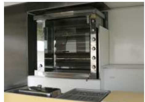
Pouletgrill mit 11 Spiessaufnahmen bei 6 Brennern
