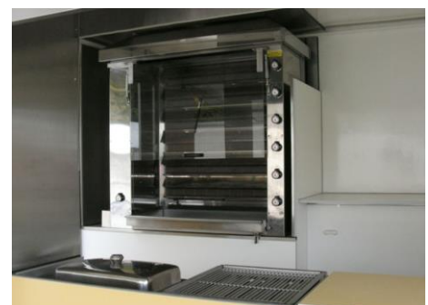
Pouletgrill mit 11 Spiessaufnahmen bei 6 Brennern
