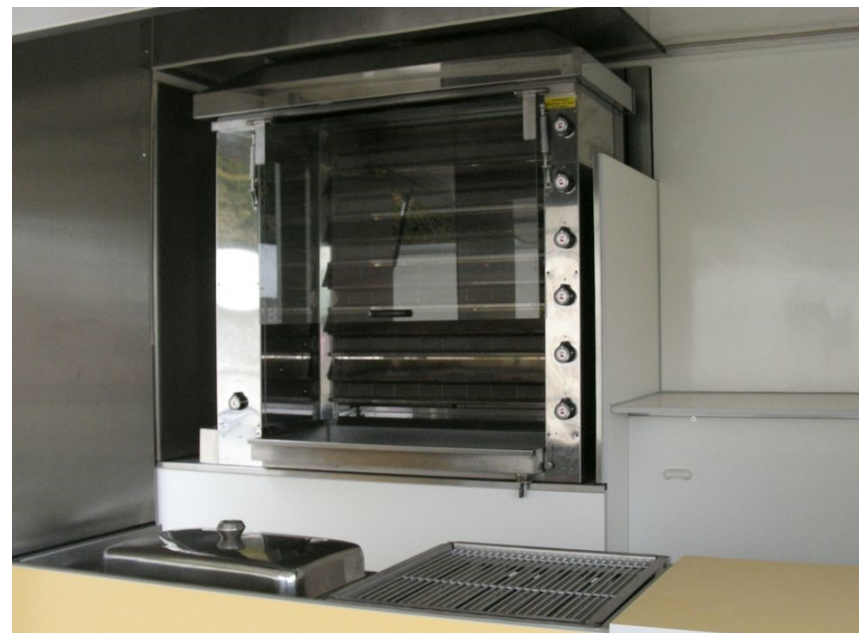
Pouletgrill mit 11 Spiessaufnahmen bei 6 Brennern
